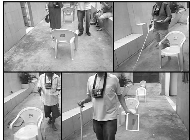
Figura 10. Execução dos testes para detecção de obstáculos terrestres
